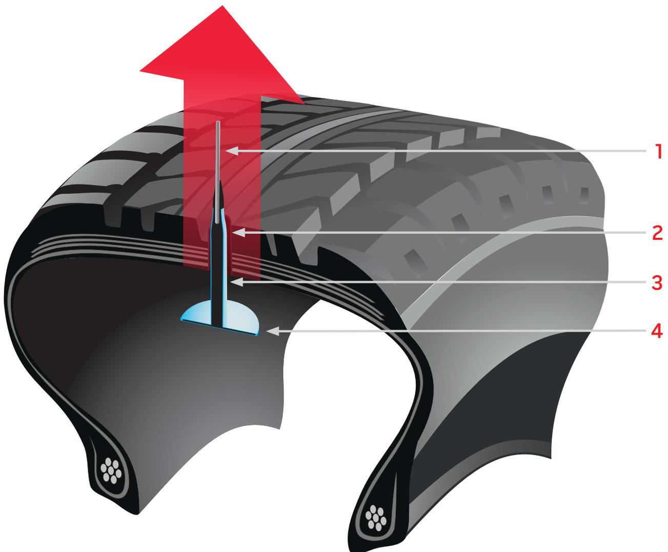
1. **Minicombi Metallstift:** ermöglicht einfaches Einziehen des Reparaturkörpers und wird nach erfolgreichem Einbau abgetrennt
